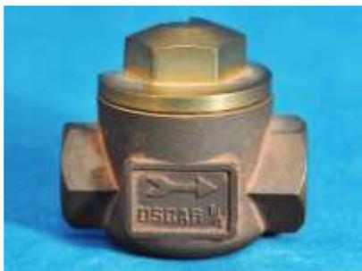
本器は一方のみ流れ、逆方向には絶対洩らさない、リフト式のチェックバルブで、ポペット部、NBR、バイトン焼付けのものは真空作動にも敏感な逆止効果を発揮し、テフロンポペットはボンド等の高粘度の液体に適し、ステンレスポペットは高圧に使用できる。
